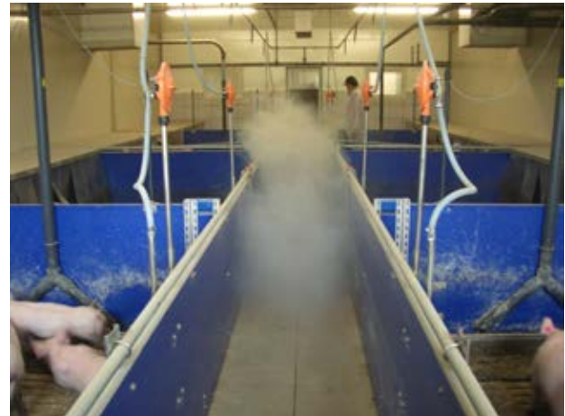
Überprüfung der Luftverteilung mit Hilfe von Nebelmaschinen
