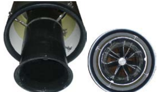
Jet-Ejektor-Düse zur Erhöhung des Volumenstroms
